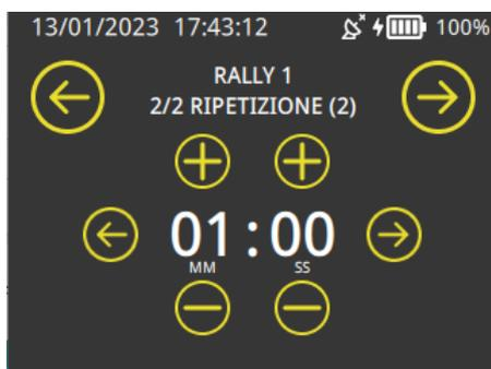
Durante l’esecuzione della sequenza si può facilmente passare da un tempo di ripetizione al successivo tramite un impulso prolungato sulla linea IN2 o selezionandolo dal menu principale tramite la freccia di fianco al tempo di ripetizione.
