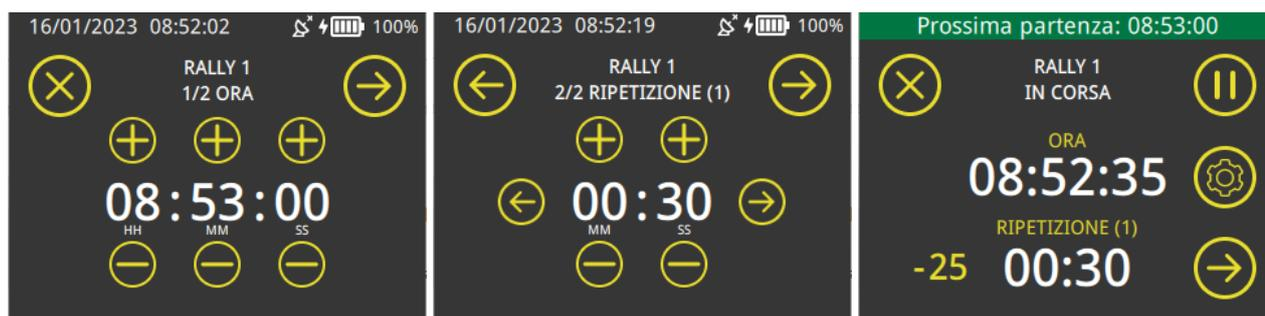
A partire da questo momento il semaforo inizierà con la sequenza ed il tempo di ripetizione selezionati. Sullo schermo touch vengono riproposti il tempo mancante allo zero con countdown e lo stato del semaforo (pallino del colore del semaforo)
