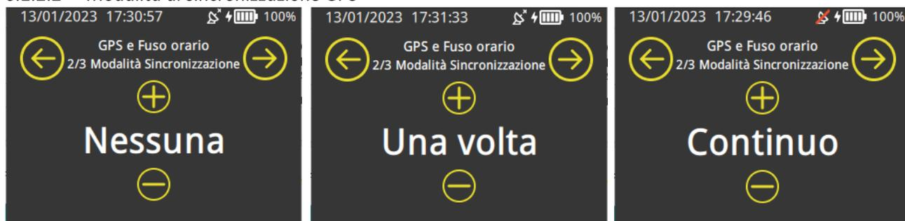
Se è selezionato il parametro “Nessuna” HiClock di fatto non utilizza la sincronizzazione GPS anche se il modulo è acceso e funzionante. Se è selezionato “Una volta” HiClock” prende la sincronizzazione GPS (impulso PPS) e poi continua con la base tempi interna. Se è selezionato “Continuo” HiClock” viene tenuto agganciato alla base tempi GPS “ri-sincronizzando” la base tempi interna ogni secondo utilizzando il segnale PPS.
