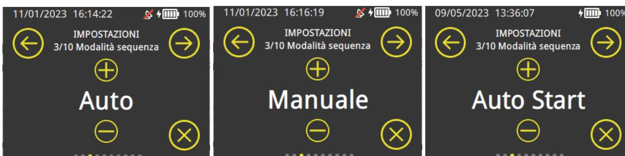
La modalità "Auto" genera in maniera continua le sequenze a partire dall'ora selezionata e con il tempo di ripetizione impostato. Al contrario la modalità "Manuale" genera la sequenza impostata solo alla pressione del pulsante (V) in alto a destra o tramite un impulso sulla linea IN2.
