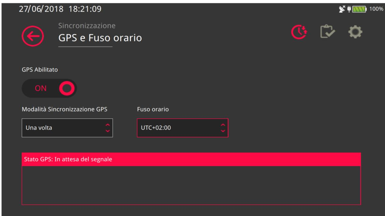
Il Rei Pro è dotato di un ricevitore GPS integrato. Lo stato della ricezione del segnale satellitare è visibile tramite l'icona posta accanto a quella della batteria:
