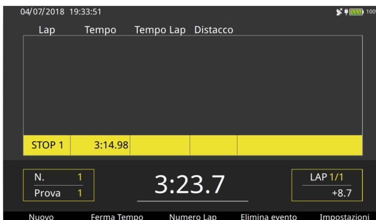
Al contrario, se avrai impostato un numero di Lap superiore ad 1, la linea di Stop resterà chiusa per il tempo di disattivazione impostato. Solo al raggiungimento dell'ultimo Lap, il comportamento sarà uguale al caso esaminato sopra. In una gara con Lap multipli il comando Ferma Tempo ti permetterà di mostrare il tempo dell'ultimo Lap ricevuto.
