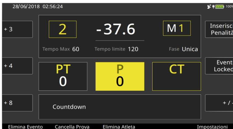
Arrivato un impulso di Start il tempo di preparazione verrà interrotto (il valore verrà indicato sulla stampata) e inizierà a correre il tempo di gara. Puoi inserire le penalità selezionando l'area penalità, come in figura e scegliendo una delle tre opzioni rapide, oppure inserendo manualmente il valore da Inserisci Penalità [D].
