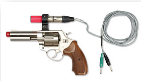
Rilevatore acustico collegato alla pistola dello starter
